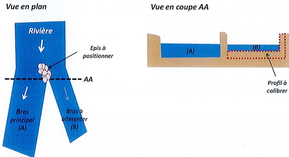
**Figure 2: Schéma de principe de la dérivation d'eau**
